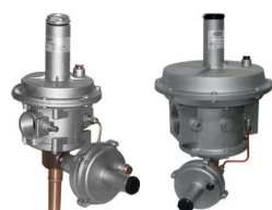
RG-2MB - DN20 - DN50 Com 2 diafragmas Com shut-off incorporado P saída até 150/200 mbar (BP) P saída até 500 mbar (AP)
