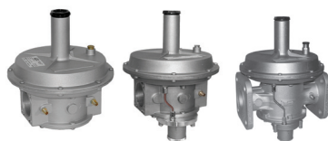
RG-2MCZ - DN 40/50 RG-2MBZ - DN 40/50 Com 2 diafragmas Com shut-off incorporado (versão B) Anéis de vedação em Viton P saída até 200 mbar (BP) P saída até 600 mbar (AP) Versão especial corpo flangeado DN 40/50
